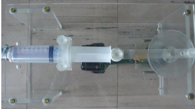
Pompa ssąco-tłocząca – widok z góry
