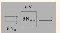
$\delta N_{stop} = \delta N_{\mu} n_o \varphi \overline{\sigma} \delta x$
